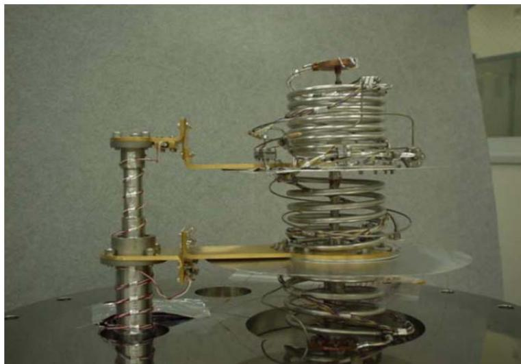
图 37. SPICA 1 K J-T 制冷机系统实物图<sup>[53]</sup>
