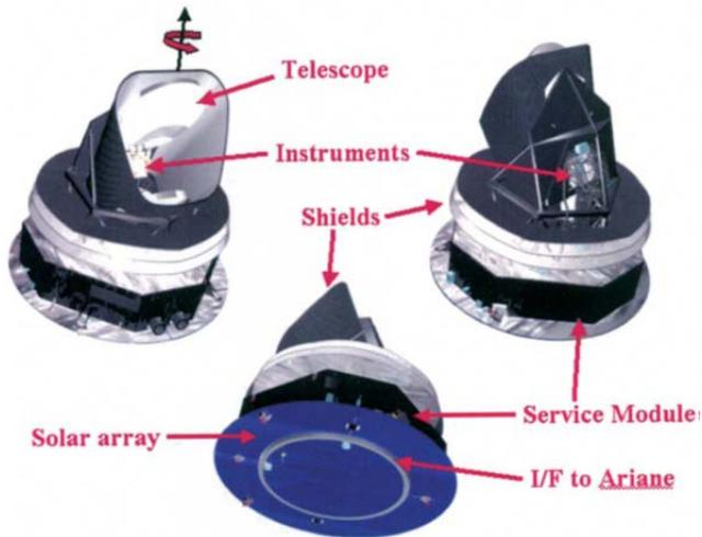
图 2. Planck 卫星主要部件布置示意图<sup>[8]</sup>
